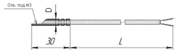
Рисунок 1 – Термопреобразователь в конструктивном исполнении К5
