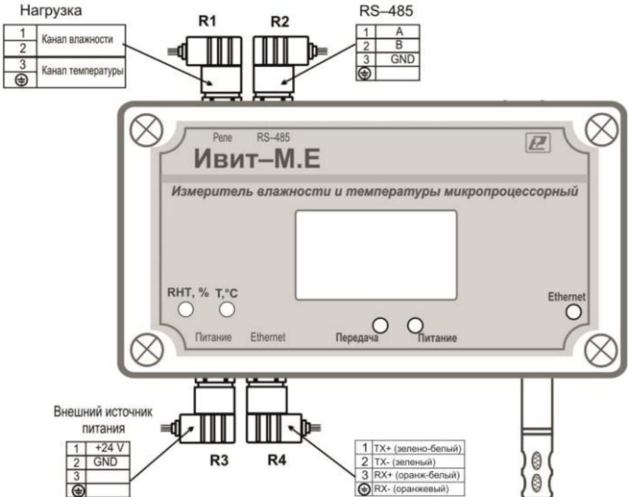
**Рисунок Д.1 – Подключение прибора на месте эксплуатации**
