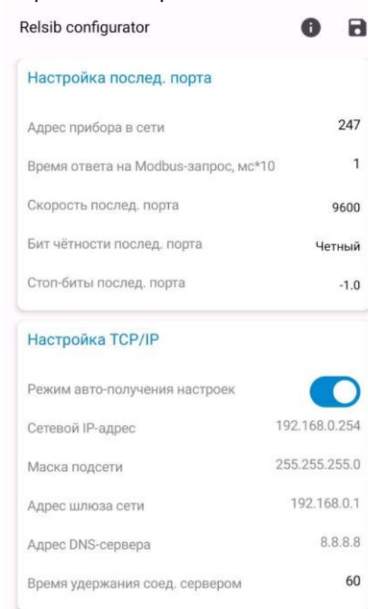
Рисунок 2 – Окно настройки прибора
