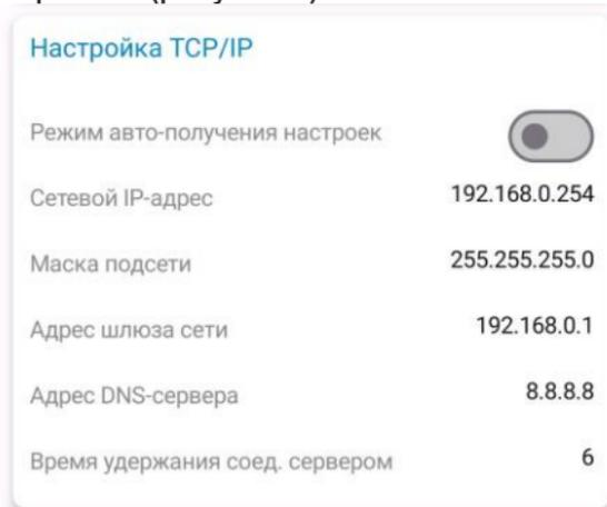
Рисунок 3 – Настройка TCP/IP
