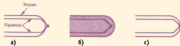
Рис. 3. Типы термопар: а) с открытым контактом; б) с изолированным незаземленным контактом; в) с заземленным контактом
