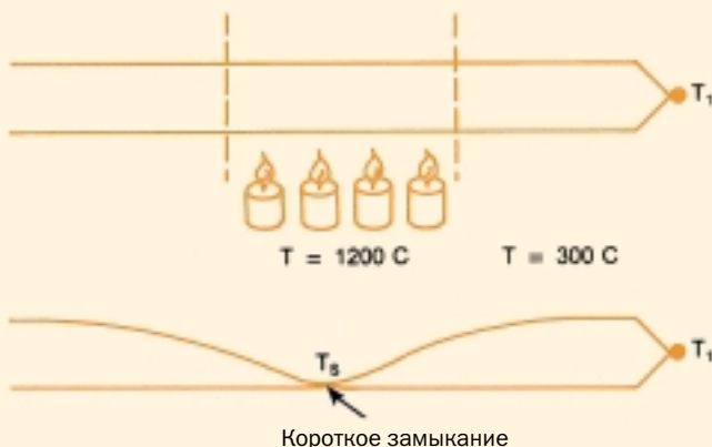
Рис. 18. Локальный нагрев термопары и изменение сопротивления
