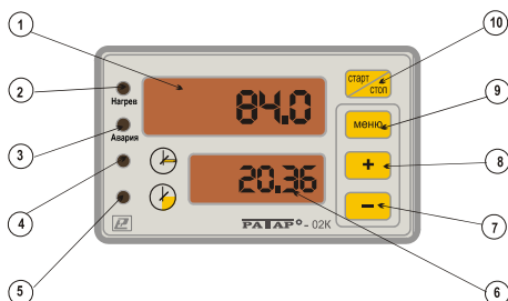
Рисунок 2 – Панель управления и индикации регулятора РАТАР-02К
