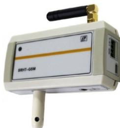
GSM-датчик температуры и относительной влажности обеспечивает постоянный и непрерывный GSM-мониторинг относительной влажности и температуры, а также протечки воды. GSM-датчик отправляет полученные данные на удаленный мобильный телефон с помощью SMS сообщений. Преимущества GSM-датчиков «Рэлсиб»:
