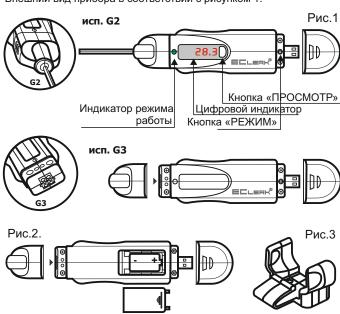
В зависимости от наличия или отсутствия цифрового индикатора прибор имеет следующие модификации:
