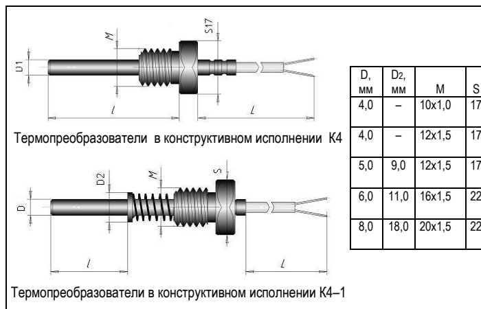
Рисунок 1 – Термопреобразователи сопротивления ТСПр и ТСМг в конструктивном исполнении К4
