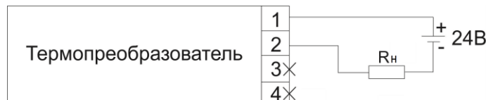
Рисунок 2 – Схема подключения термопреобразователя
